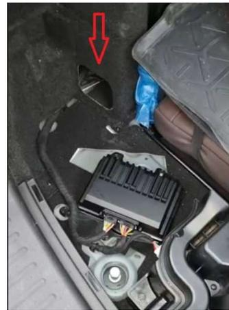
6.1. Фотография блока управления полным приводом 3LN (производства Китай):
